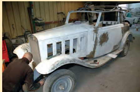
Glimt frå karosseri restaurering i Polen. Mykje nytt stål måtte til.
