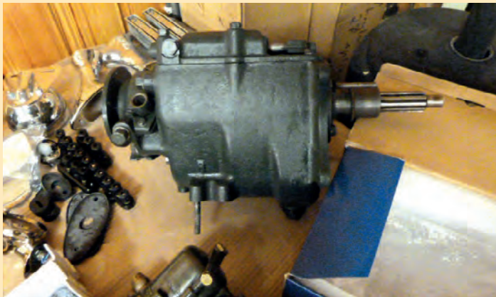
Fransk tretrinn girkasse med tommemål innvendig.
