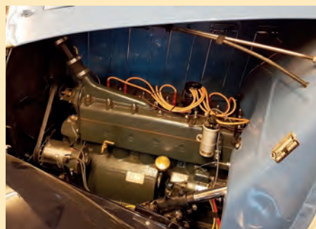
Sideventilert motor på 2,6 liter og 56 HK.
