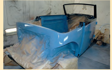
Glimt frå karosseri restaurering i Polen. Mykje nytt stål måtte til.
